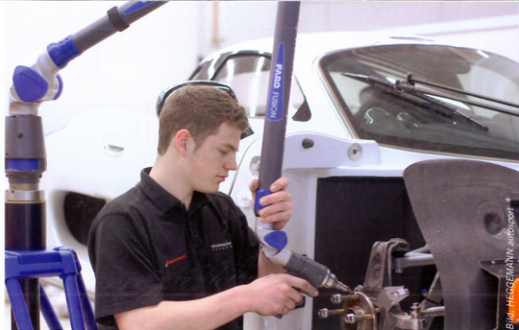
Kein Stau mehr in der Qualitätssicherung: Montagekontrolle mit dem FaroArm Fusion
